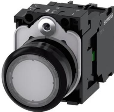
pulsante luminoso, 22 mm, rotondo, in plastica, trasparente, bottone, piatto, ad impulso, con supporto, 1 NO, modulo LED con LED integrato AC/DC 24V, morsetto a vite
