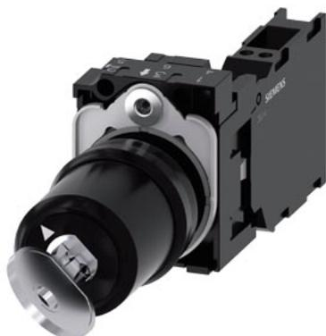
selettore a chiave Siemens, 22 mm, rotondo, in plastica, numero serratura SSG10, con 2 chiavi, 2 posizioni di commutazione O-I, permanente, 10:30 h/13:30 h, estrazione chiave O+I, con supporto, 1 NO+1 NC, morsetti a molla
