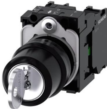
selettore a chiave RONIS, 22 mm, rotondo, in plastica, numero serratura SB30, con 2 chiavi, 3 posizioni di commutazione I-O-II, permanente, 10:30 h/12 h/13:30 h, estrazione chiave I+O+II, con supporto, 1 NO, 1 NO, morsetto a vite, possibili serrature speciali: SB31, 421, 455
