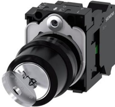
selettore a chiave RONIS, 22 mm, rotondo, in plastica, numero serratura SB30, con 2 chiavi, 2 posizioni di commutazione O-I, permanente, 10:30 h/13:30 h, estrazione chiave O+I, con supporto, 1 NO, morsetti a molla, possibili serrature speciali: SB31, 421, 455
