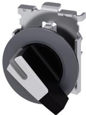
selettore, illuminabile, 30 mm, rotondo, in metallo, opaco, bianco, selettore, lungo, anello frontale per montaggio piatto, 2 posizioni di commutazione O<I, ad impulso, angolo di comando 45°, 10:30 h/12 h
