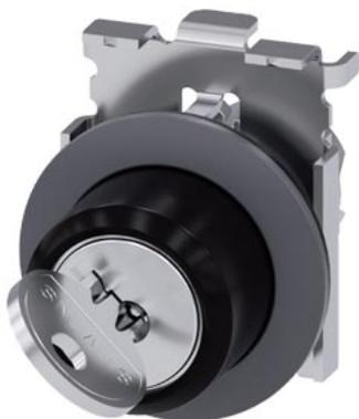
selettore a chiave RONIS, 30 mm, rotondo, in metallo, opaco, anello frontale per montaggio piatto, numero serratura SB30, con 2 chiavi, 2 posizioni di commutazione O-I, permanente, angolo di intervento 90°, 10:30 h/13:30 h, estrazione chiave O+I, possibili serrature speciali: SB31, 421, 455
