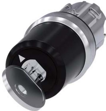
selettore a chiave BKS, 22 mm, rotondo, in metallo, lucido, numero serratura S1, con 2 chiavi, 2 posizioni di commutazione O-I, permanente, angolo di intervento 90°, 10:30 h/13:30 h, estrazione chiave O+I
