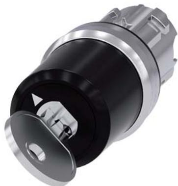
selettore a chiave Siemens, 22 mm, rotondo, in metallo, lucido, numero serratura STGH10, con 2 chiavi, 2 posizioni di commutazione O-I, permanente, angolo di comando 90°, 10:30 h/13:30 h, estrazione chiave O+I
