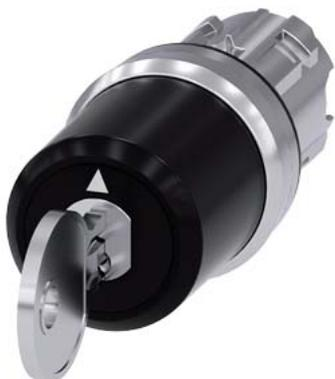
selettore a chiave Siemens, 22 mm, rotondo, in metallo, lucido, numero serratura SSG10, con 2 chiavi, 3 posizioni di commutazione I-O<I, permanente a sinistra, ad impulso a destra, angolo di comando 2x45°, 10:30 h/12 h/13:30 h, estrazione chiave O+I
