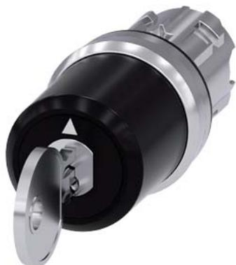
selettore a chiave Siemens, 22 mm, rotondo, in metallo, lucido, numero serratura SSG10, con 2 chiavi, 3 posizioni di commutazione I-O-II, permanente, angolo di comando 2x45°, 10:30 h/12 h/13:30 h, estrazione chiave I+O+II
