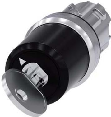
selettore a chiave Siemens, 22 mm, rotondo, in metallo, lucido, numero serratura SSG10, con 2 chiavi, 2 posizioni di commutazione O-I, permanente, angolo di comando 90°, 10:30 h/13:30 h, estrazione chiave O+I
