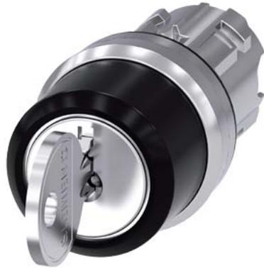
selettore a chiave RONIS, 22 mm, rotondo, in metallo, lucido, numero serratura SB30, con 2 chiavi, 3 posizioni di commutazione I>O<II, ad impulso, angolo di commutazione 2x45°, 10:30 h/12 h/13:30 h, estrazione chiave O, possibili serrature speciali: SB31, 421, 455
