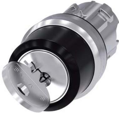
selettore a chiave RONIS, 22 mm, rotondo, in metallo, lucido, numero serratura SB30, con 2 chiavi, 2 posizioni di commutazione O-I, permanente, angolo di intervento 90°, 10:30 h/13:30 h, estrazione chiave O, possibili serrature speciali: SB31, 421, 455
