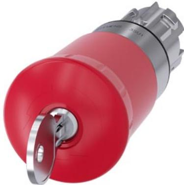
pulsante a fungo di ARRESTO DI EMERGENZA, 22 mm, rotondo, in metallo, lucido, rosso, 40 mm, con serratura Siemens, numero serratura SSG10, permanente con blocco positivo, secondo EN ISO 13850, sblocco a chiave
