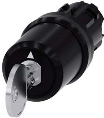
selettore a chiave BKS, 22 mm, rotondo, in plastica, numero serratura S1, con 2 chiavi, 3 posizioni di commutazione I-O-II, permanente, angolo di commutazione 2x45°, 10:30 h/12 h/13:30 h, estrazione chiave I+II
