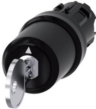
selettore a chiave Siemens con controllo della chiave, 22 mm, rotondo, in plastica, numero serratura SSG10 con 2 chiavi, 3 posizioni di commutazione I-O-II, permanente, angolo di comando 2x45°, 10:30 h/12 h/13:30 h, estrazione chiave/espulsione chiave in O
