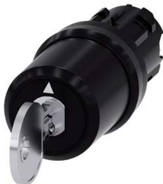
selettore a chiave Siemens, 22 mm, rotondo, in plastica, numero serratura SSG10, con 2 chiavi, 3 posizioni di commutazione I>O<II, ad impulso, angolo di comando 2x45°, 10:30 h/12 h/13:30 h, estrazione chiave O
