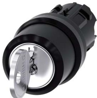
selettore a chiave RONIS, 22 mm, rotondo, in plastica, numero serratura SB30, con 2 chiavi, 3 posizioni di commutazione I-O-II, permanente, angolo di commutazione 2x45°, 10:30 h/12 h/13:30 h, estrazione chiave I+II, possibili serrature speciali: SB31, 421, 455
