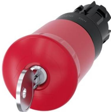
pulsante a fungo di ARRESTO DI EMERGENZA, 22 mm, rotondo, in plastica, rosso, 40 mm, con serratura Siemens, numero serratura SSG10, permanente con blocco positivo, secondo EN ISO 13850, sblocco a chiave
