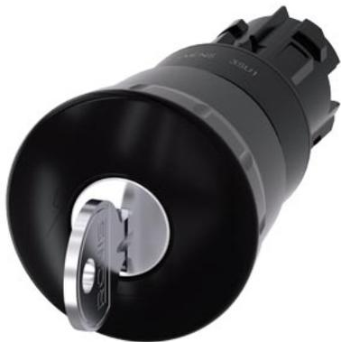
pulsante a fungo, 22 mm, rotondo, in plastica, nero, 40 mm, con serratura RONIS, numero serratura 455, permanente con blocco positivo, secondo DIN EN ISO 13850, sblocco a chiave
