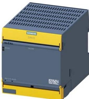
dispositivo di sicurezza SIRIUS modulo di ampliamento uscite 3RO Power, con circuiti di abilitazione a relè 3 contatti NO più circuito di segnalazione relè 1 NC Us = AC 115 V morsetto a molla (Push-in)
