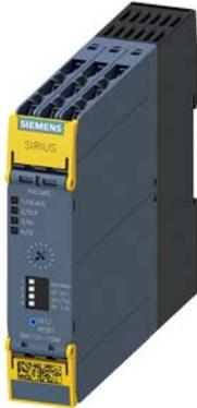
dispositivo di sicurezza SIRIUS apparecchio di base serie Advanced con ritardo 0,05-3 s circuiti di abilitazione a relè 2 NO istantaneo 2 NO con ritardo  $U_s = DC 24 V$  morsetto a vite
