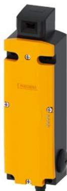
interruttore di posizione di sicurezza con blocco di ritenuta, forza di ritenuta 2600 N, 5 direzioni di accostamento, custodia in metallo, connettore M12, ASIsafe integrato, canale 1=azionatore 1NC, canale 2=magnete 1NC, con blocco magnetico, tensione magnete AC/DC 24 V. Non è necessaria un'alimentazione 24 V supplementare. sorveglianza azionatore 2NC/1NO sorveglianza magnete 2NC/1NO l'azionatore separato adeguato 3SE5000-0AV0../-0AW5. deve essere ordinato separatamente.
