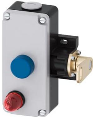
interruttore a fune con leva custodia in metallo; 2 x M25 x1,5; 2 NO+2 NC, blocco secondo EN13850 e sblocco a pulsante con lampada LED, rosso, DC 24 V, comando bilaterale, per lunghezze della fune fino a 2 x 100 m
