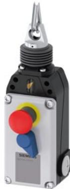
interruttore a fune con arresto di emergenza custodia in metallo IP67, 3 xM20 x1,5; contatti ad azione lenta 1NO+3NC; blocco di ritenzione secondo EN ISO 13850 con sblocco a rotazione, per lunghezze fune fino a 75 m
