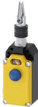
interruttore a fune custodia in metallo, 2x M20 x 1,5; con coperchio giallo, 2 NC/1 NO, con blocco EN ISO 13850 e sblocco a pulsante per lunghezze della fune fino a 5 m
