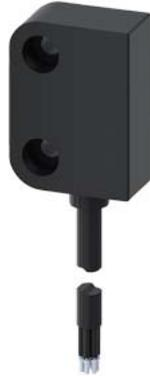
blocchetto di contatti interruttore magnetico rettangolare, piccolo 26 x 36 mm, per battuta porta a destra, elementi di contatto: contatti di sicurezza 2NC, contatto di segnalazione 1NC, con cavo di collegamento di 3 m senza LED, l'adeguato magnete di comando 3SE6714-3CA oppure ruotato di 90° 3SE6724-3CA
