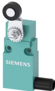
interruttore di posizione larghezza 30 mm nella forma costruttiva compatta con connettore fisso M12 contatti ad azione rapida 1NO+1NC con leva girevole
