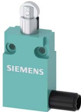
interruttore di posizione larghezza 30 mm nella forma costruttiva compatta con connettore fisso M12 contatti ad azione rapida 1NO+1NC con pulsante con rotella
