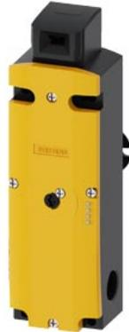
fincorsa di sicurezza con blocco di ritenuta forza di ritenuta 1300 N 5 direzioni di accostamento blocco meccanico a molla sblocco di emergenza posteriore e sblocco ausiliario anteriore tensione del magnete AC 230 V sorveglianza attuatore 2NC/1NO sorveglianza magnete 2NC/1NO indicatore a LED giallo/verde L'attuatore non è compreso nella dotazione di fornitura. attuatore 3SE5000-0AV0. da ordinare separatamente
