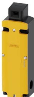
fincorsa di sicurezza con blocco di ritenuta forza di ritenuta 1300 N 5 direzioni di accostamento con blocco magnetico tensione del magnete AC 115 V sorveglianza attuatore 2NC/1NO sorveglianza magnete 2NC/1NO indicatore a LED giallo/verde L'attuatore non è compreso nella dotazione di fornitura. attuatore 3SE5000-0AV0. da ordinare separatamente
