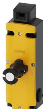
fincorsa di sicurezza con blocco di ritenuta forza di ritenuta 2600 N 5 direzioni di accostamento blocco meccanico a molla sblocco di fuga frontale tensione del magnete DC 24 V sorveglianza attuatore 2NC/1NO sorveglianza magnete 2NC/1NO indicatore a LED giallo/verde L'attuatore non è compreso nella dotazione di fornitura. attuatore 3SE5000-0AV0. da ordinare separatamente
