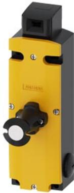
finecorsa di sicurezza con blocco di ritenuta forza di ritenuta 2600 N 5 direzioni di accostamento blocco meccanico a molla sblocco di fuga frontale tensione del magnete AC 115 V sorveglianza attuatore 2NC/1NO sorveglianza magnete 2NC/1NO L'attuatore non è compreso nella dotazione di fornitura. attuatore 3SE5000-0AV0. da ordinare separatamente
