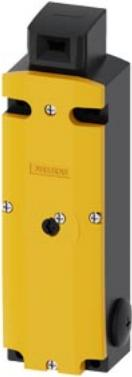
finecorsa di sicurezza con blocco di ritenuta forza di ritenuta 2600 N 5 direzioni di accostamento blocco meccanico a molla sblocco ausiliario anteriore tensione del magnete DC 24 V sorveglianza attuatore 2NC/1NO sorveglianza magnete 2NC/1NO L'attuatore non è compreso nella dotazione di fornitura. attuatore 3SE5000-0AV0. da ordinare separatamente
