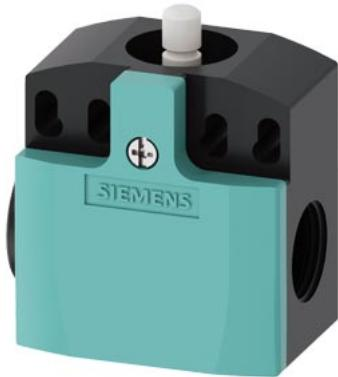
interruttore di posizione custodia in plastica, 50 mm collegamento apparecchio 2x (M20x 1,5) 2NO/NC contatti ad azione lenta pulsante a calotta, forma B
