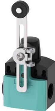
interruttore di posizione custodia in plastica 50 mm, collegamento apparecchio 2 x (M20 x 1,5) contatti ad azione rapida 1NO/1NC, regolabile in lunghezza leva girevole impostabile a destra/a sinistra con rotella in plastica 19 mm
