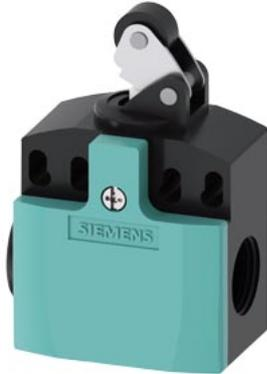
interruttore di posizione custodia in plastica 50 mm, collegamento apparecchio 2 x (M20 x 1,5) contatti ad azione rapida 1NO/1NC, leva con rotella in plastica 13 mm
