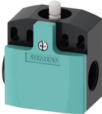
interruttore di posizione custodia in plastica 50 mm, collegamento apparecchio 2 x (M20 x 1,5) 1S/1Ö integrato (non sostituibile) contatti ad azione rapida, pulsante a calotta
