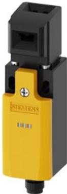
finecorsa di sicurezza con azionatore separato custodia in plastica, 31 mm secondo DIN EN 50047 contatti ad azione lenta 1NO/1NC con connettore M12, a 5 poli, fisso con 2 LED giallo/verde DC 24 V, 5 direzioni di azionamento Assegnazione dei pin: Pin1=21, Pin2=22 Pin3=14 e LED verde, Pin4=13 e LED giallo Pin5=LED di massa il relativo azionatore adeguato separato 3SE5000-0AV0. deve essere ordinato separatamente
