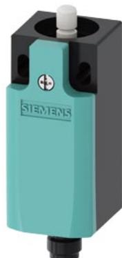
interruttore di posizione custodia in plastica secondo EN 50047, 31 mm contatti ad azione rapida 1NO/1NC integrato (non sostituibile) con connettore M12, a 4 poli assegnazione dei pin: pin1=21, pin2=22 pin3=13, pin4=14 per massimo 250 V e 4 A, con pulsante a calotta,
