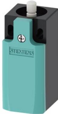
interruttore di posizione custodia in plastica secondo EN 50047, 31 mm collegamento apparecchio 1 x (M20 x 1,5) contatti ad azione lenta 1NO/2NC pulsante a calotta, forma B
