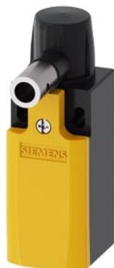
interruttore a cerniera custodia in plastica, 31 mm secondo DIN EN 50047 adatta per -40 °C collegamento apparecchio 1 x (M20 x 1,5) contatto ad azione rapida 1NC/1NO integrato, con albero cavo diametro = 8 mm, Angolo di intervento 10°
