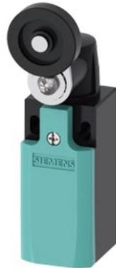
interruttore di posizione custodia in plastica secondo DIN EN 50047, 31 mm collegamento apparecchio 1 x (M20 x 1,5) contatti ad azione rapida 1NO/1NC integrato (non sostituibile) leva girevole, lunga 21 mm impostabile a destra/a sinistra con rotella in plastica 30 mm
