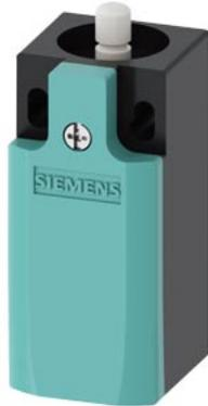
interruttore di posizione custodia in plastica secondo EN 50047, 31 mm collegamento apparecchio 1 x (M20 x 1,5) contatti ad azione rapida 1NO/1NC integrato (non sostituibile) pulsante a calotta forma B
