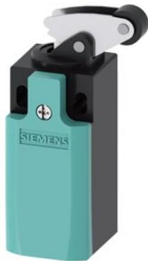
interruttore di posizione custodia in plastica secondo DIN EN 50047, 31 mm collegamento apparecchio 1 x (M20 x 1,5) contatti ad azione lenta 1NO/1NC pulsante angolato con rotella con rotella in plastica 13 mm
