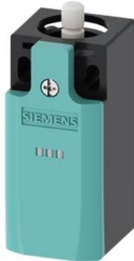
interruttore di posizione custodia in metallo secondo DIN EN 50047, 31 mm collegamento apparecchio 1 x (M20 x 1,5) contatti ad azione lenta 1NO/2NC con 2 LED giallo/verde, AC 230V
