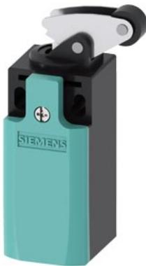
interruttore di posizione custodia in metallo secondo DIN EN 50047, 31 mm collegamento apparecchio 1 x (M20 x 1,5) contatti ad azione lenta 1NO/2NC leva angolare con rotella con rotella in plastica 13 mm
