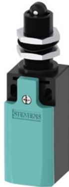
interruttore di posizione custodia in metallo IP66/IP67 secondo DIN EN 50047, 31 mm collegamento apparecchio 1 x (M20 x 1,5) contatti ad azione lenta 1NO/2NC pulsante con rotella con fissaggio centrale e rotella in plastica 10 mm
