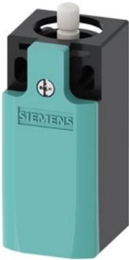
interruttore di posizione con elevata protezione contro la corrosione custodia in metallo secondo DIN EN 50047, 31 mm collegamento apparecchio 1 x (M20 x 1,5) contatti ad azione rapida 1NO/1NC (sostituibile) con perno
