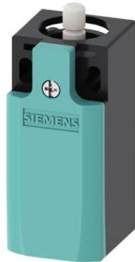
interruttore di posizione custodia in metallo secondo DIN EN 50047, 31 mm collegamento apparecchio 1 x (M20 x 1,5) contatti ad azione rapida 1NO/1NC (sostituibile) pulsante a calotta, Forma B
